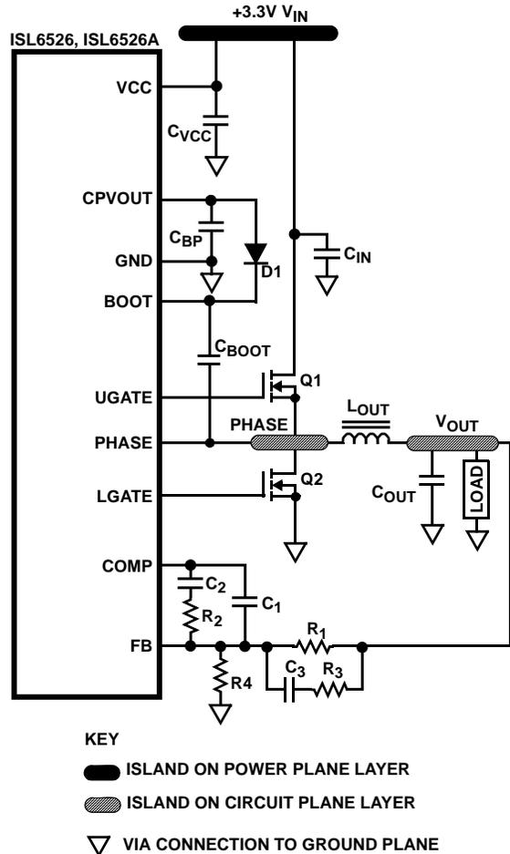
**FIGURE 4. PRINTED CIRCUIT BOARD POWER PLANES AND ISLANDS**
