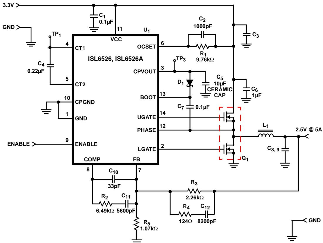
FIGURE 8. 3.3V TO 2.5V 5A DC/DC CONVERTER
