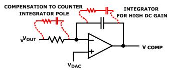
FIGURE 12. INTEGRATOR ERROR-AMPLIFIER CONFIGURATION
