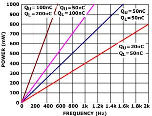
FIGURE 20. POWER DISSIPATION vs FREQUENCY
