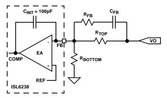
FIGURE 27. COMPENSATION REFERENCE CIRCUIT
