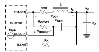
FIGURE 26. OVERCURRENT-SET CIRCUIT
