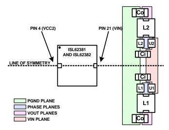
FIGURE 30. SYMMETRIC LAYOUT GUIDE
