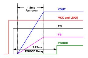
FIGURE 24. SOFT-START SEQUENCE FOR ONE SMPS
